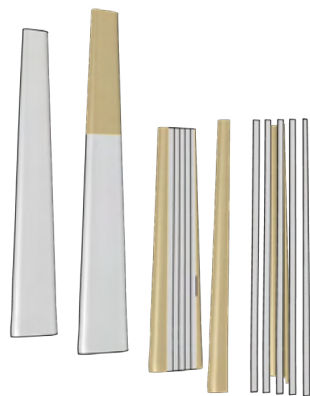
Extraction des éléments de structures des brises
