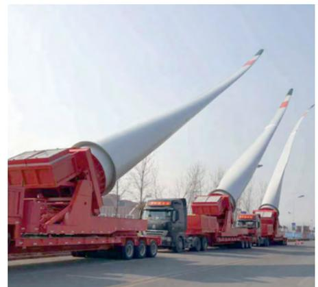
Camion géant semi-remorque pour pale d'éolienne avec chevalet transport
