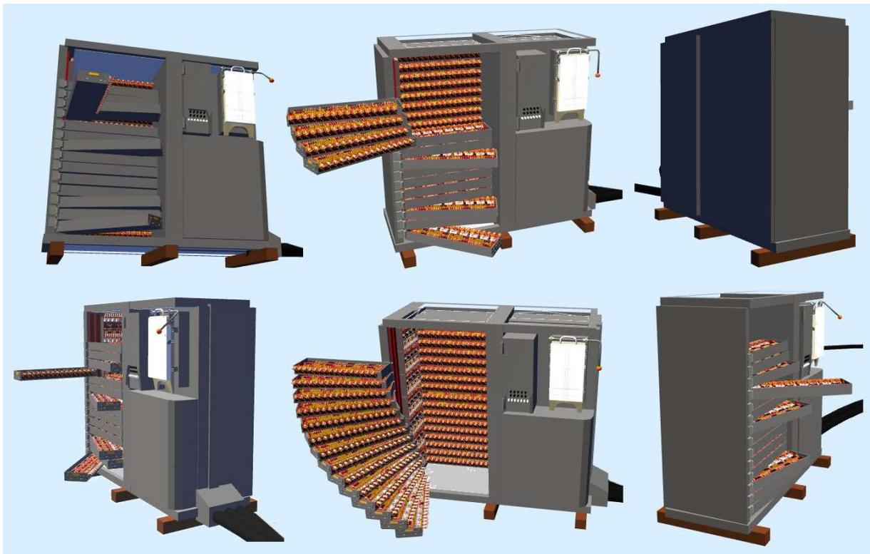
On peut manipuler un modèle 3D de l'ordinateur Bull Gamma 3 disponible sur Internet. Cliquer un organe de ce modèle fait apparaître une fenêtre d'explication du fonctionnement de l'organe. ([https://www.aconit.org/histoire/Gamma-3/Simulateur 3D/](https://www.aconit.org/histoire/Gamma-3/Simulateur%203D/), travail en cours)
