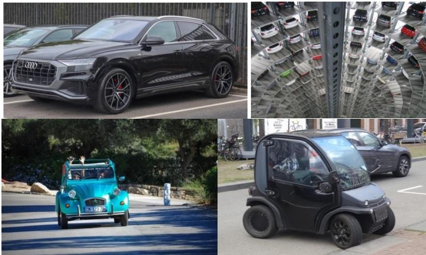
Dans la lignée de la Ford T (1908) puis de la Fiat Topolino (1936), la 2CV (1949) reste une des figures symboliques du *Low Tech* roulant. Moins de 500 kg, un bloc moteur de 600 cm<sup>3</sup>, et d'une consommation en carburant deux fois moindre que nombre de SUV roulant de nos jours. C'est-à-dire 70 ans plus tard.
