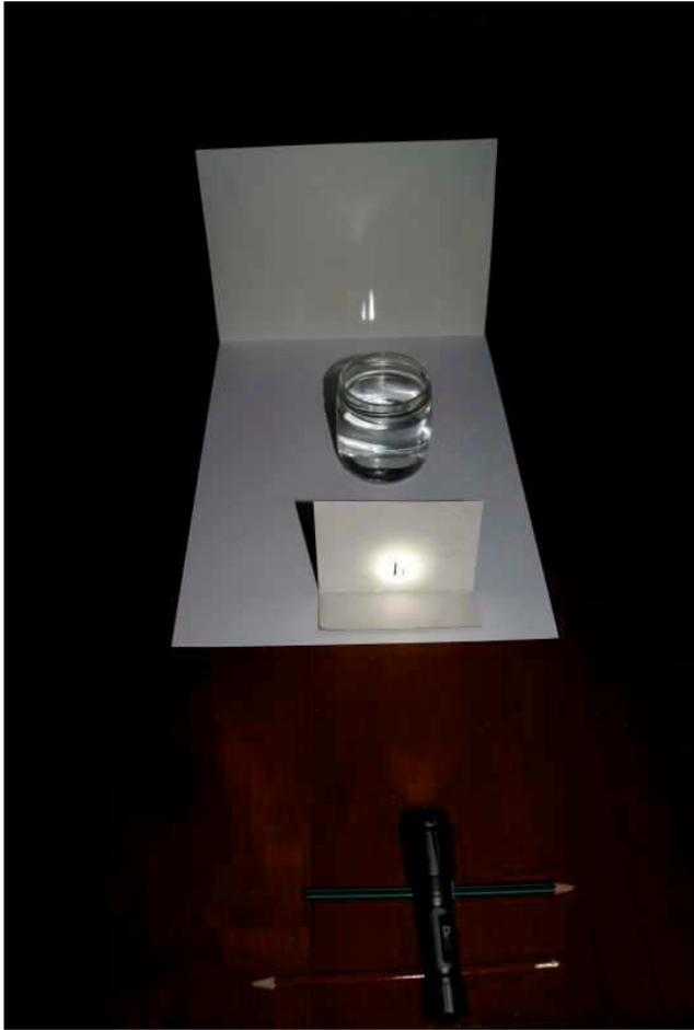
Montage permettant de réaliser avec la "lentille-bocal" l'image de deux fentes éclairées par la lampe torche.
