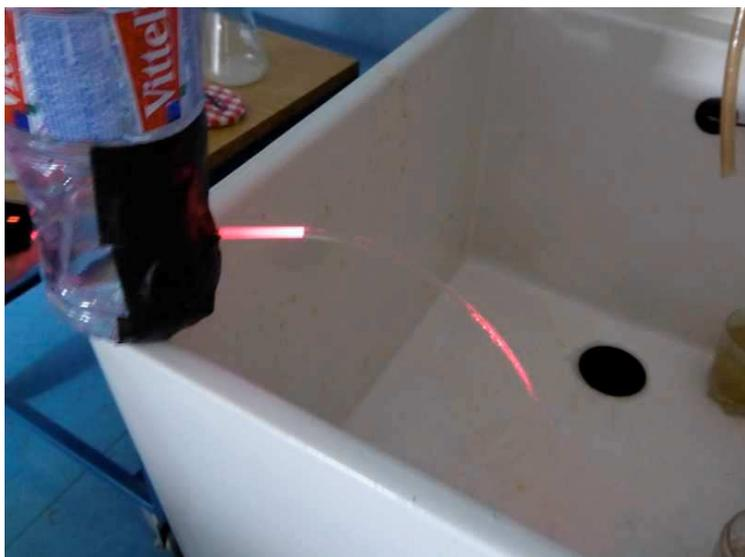
Gros plan (à gauche) et guidage de la lumière par un filet d'eau s'échappant de la bouteille percée (à droite). La lumière réapparaît à l'extrémité du jet lorsque ses parois ne sont plus lisses et diffusent la lumière.
