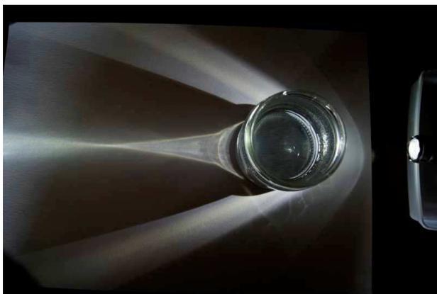
Focalisation de la lumière par le bocal rempli d'eau. De part et d'autre du bocal on voit la trace de la lumière qui est passée à l'extérieur du bocal et qui n'est donc pas focalisée
