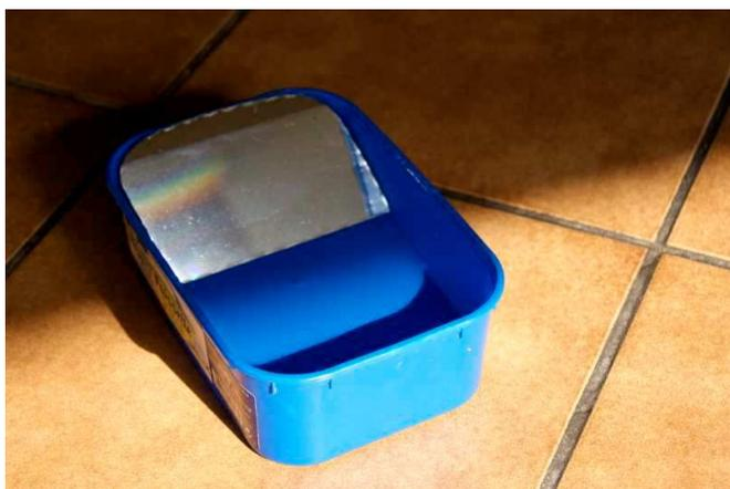
Réalisation d'un "prisme d'eau" avec la boîte, le miroir et l'eau
