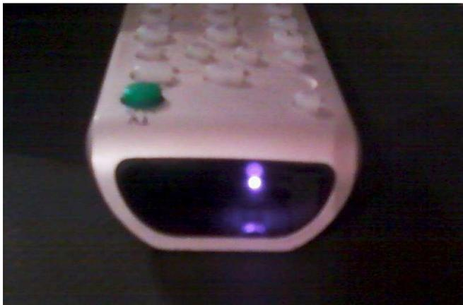
Aspect d'une télécommande de poste de TV photographié par un téléphone portable. La tache violette correspond à la lumière infra-rouge émise lorsqu'on appuie sur une commande, invisible à l'oeil, mais détectée par la caméra du téléphone. Cette lumière apparaît violette car transmise par les filtres bleu et rouge, -mais arrêtée par le filtre vert- qui permettent de reproduire des images couleurs.
