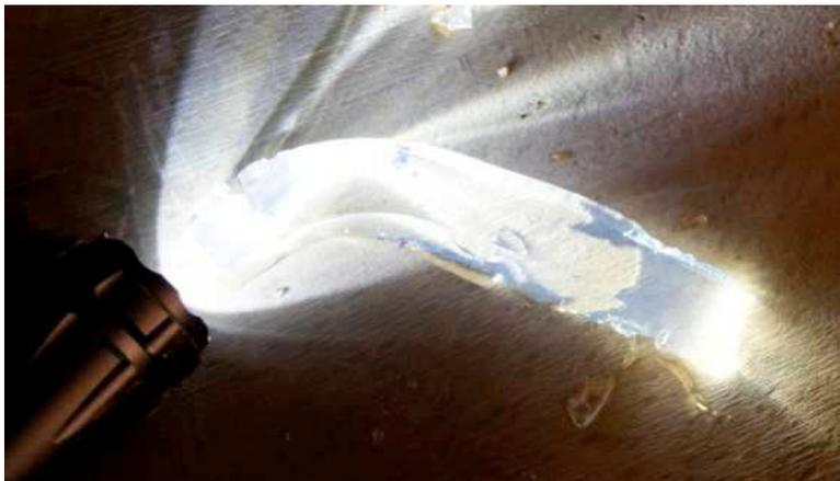
Eclairement de l'extrémité d'un bâton de gélatine avec une lampe-torche. Une partie du faisceau de lumière est guidée à l'intérieur du bâton et ressort à l'autre extrémité.
