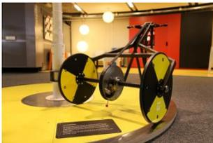
Quand une voiture prend un virage, il est nécessaire qu'elle soit dotée d'un mécanisme qui permette aux roues gauches et droites de tourner à des vitesses différentes faute de quoi la voiture patine. Ce mécanisme très rusé s'appelle le différentiel. Un magnifique modèle très didactique de différentiel est présenté ici. Le visiteur peut tester le différentiel en le laissant en fonction ou en le bloquant et observer le résultat.
