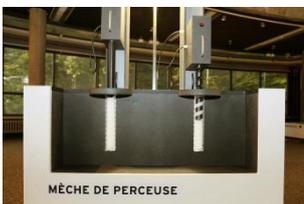
Cette expérience permet de faire comprendre à quoi sert le sillon creusé le long des mèches de perceuses. Le visiteur peut tester deux sortes de perceuses : une avec un sillon hélicoïdal et l'autre sans sillon, toute lisse. Un système de vitre permet de voir le trou percé par la mèche et la façon dont la matière est rejetée grâce à ce sillon.
