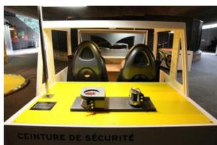
Pourquoi une ceinture de sécurité ne se bloque-t-elle que quand on tire fort dessus ? Un modèle géant de ceinture permet de comprendre le mécanisme simple qui autorise cette astucieuse fonctionnalité. Assis dans des fauteuils de voiture, le visiteur peut tester les ceintures, puis aller observer ce fameux mécanisme.
