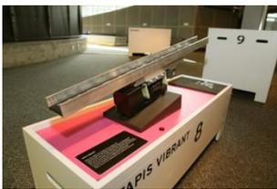
En relation avec le convoyeur à rouleaux et le vibreur de téléphone portable, cette expérience présente un moyen étonnant, utilisé dans l'industrie, pour déplacer des pièces d'un endroit à un autre. Grâce à ce tapis vibrant, on peut faire monter des pièces.
