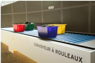
A l'époque du néolithique, les hommes utilisaient déjà des rouleaux pour déplacer de grosses pierres. Cette technique est encore utilisée aujourd'hui dans les centres de tri postaux, les aéroports ou les usines. Une expérience pour réfléchir aux différents moyens de déplacer du matériel. Des bacs remplis de pucks de hockey permettent de tester l'efficacité de ses rouleaux.
