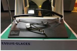
Cette expérience montre le mécanisme très élégant qui se cache entre le moteur qui alimente l'essuie-glace et le mouvement des balais des essuie-glaces eux-mêmes. Elle permet de s'imaginer que d'un mouvement de rotation simple, on peut aboutir à un mouvement synchronisé plus complexe grâce à des leviers.
